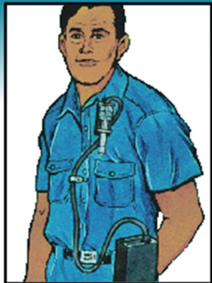
وسیله نمونه بردار فردی از گرد غبار (توضیحات بیشتر در روش NIOSH)
