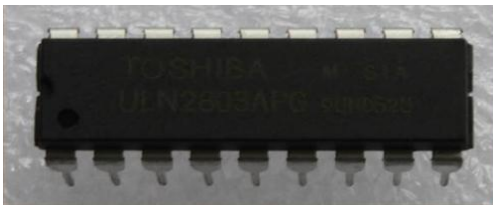
شکل ۱-۲ (ای سی ۲۸۰۳ ULN برای تقویت جریان)
