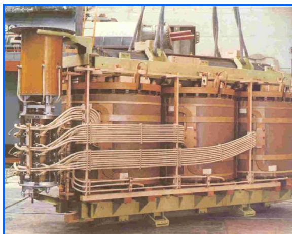
شکل ۱۰-۱ دو دستگاه ترانسفورماتور قدرت فشارقوی برش خورده با تپ چنجر On - Load
