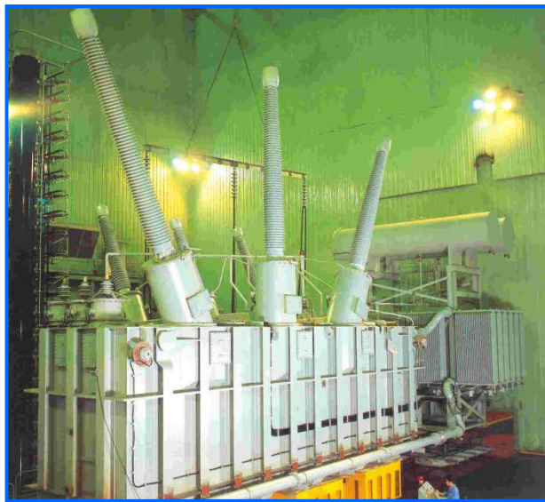
شکل ۶-۱ ترانسفورماتور قدرت فشارقوی با توان ۵۰۰ MVA و ولتاژ KV ۱۱۵ / ۵۲۵
