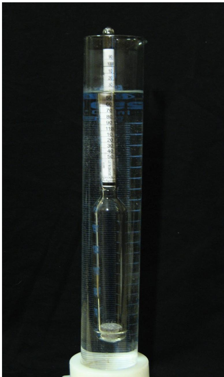
استفاده از هیدرومتر برای اندازه گیری چگالی مخصوص یک محلول
