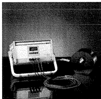
شکل ۵- یک نمونه دستگاه Zero - flux
