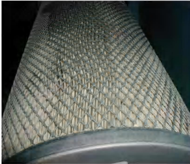
شکل ۲۰: چگونگی نفوذ آب درون فیلترهای هوایی. انحراف شیارهای فیلتر فشنگی
