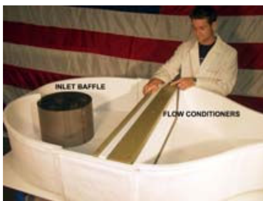
شکل ۲-۱۴) کاربرد فقط شبکه لانه زنبوری در تونل آب رو باز
