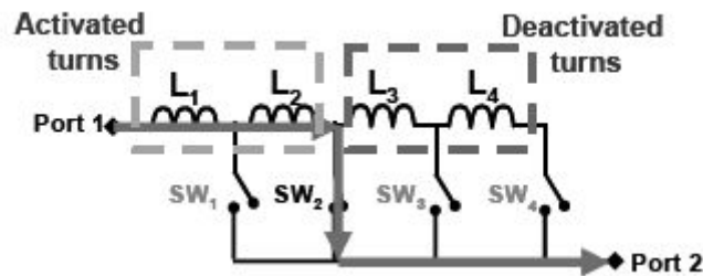
شکل ۴-۳۱: شماتیک سلف قابل تنظیم گسسته به کمک سوئیچ [31]
