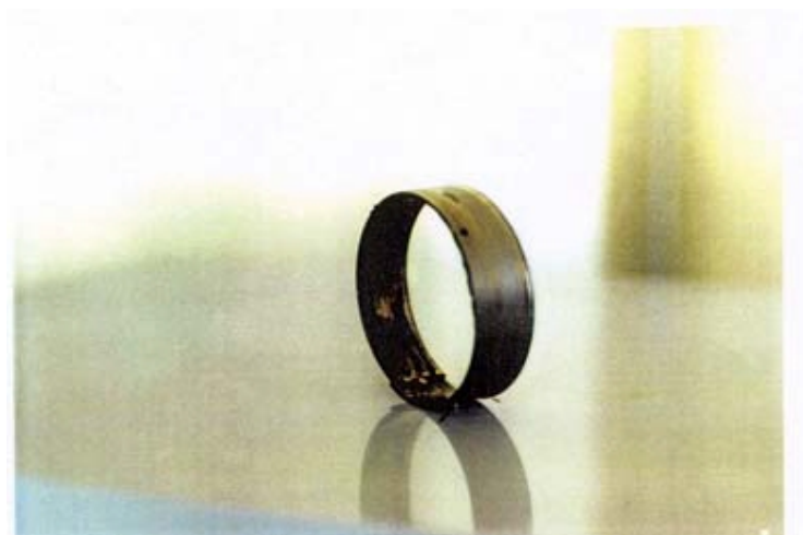
شکل (4-4) نمونه هائی از پیش بینی تعمیرات براساس نتایج آنالیز روغن
