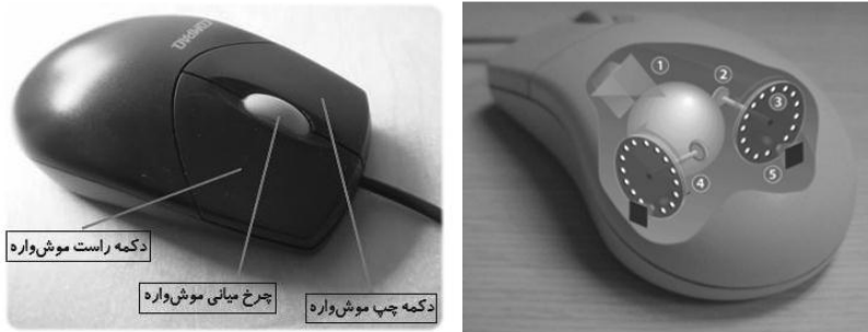
شکل ۲-۸: ساختار موشواره رایانه
