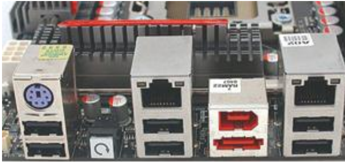
شکل ۲-۲۸: برد اصلی با کلید پاک کننده ی سی موس در پنل پشتی
