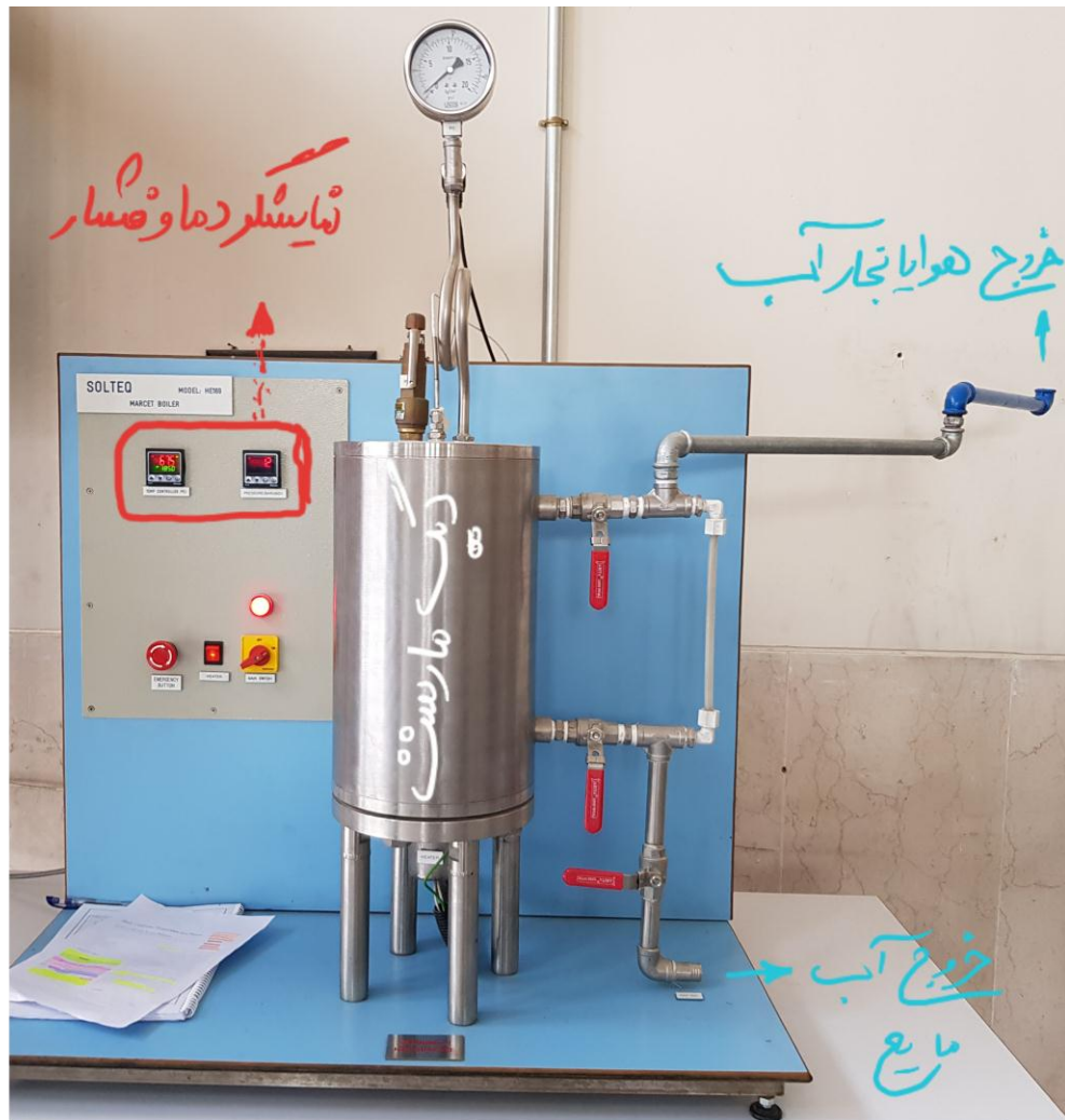
شکل ۱ دیگ مارست و تجهیزات اندازه گیری
