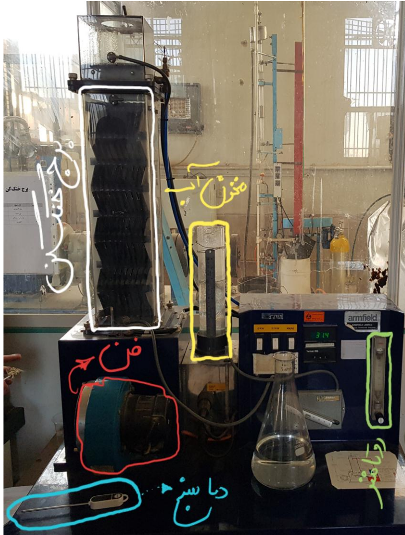
شکل ۱ برج خنک کن و تجهیزات اندازه گیری
